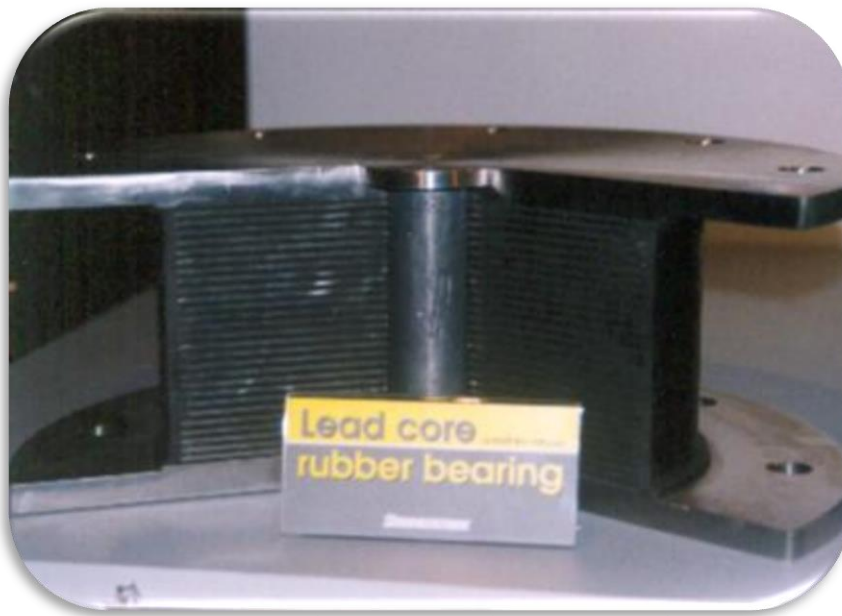
شکل ۴: سیستم جداساز لرزه‌ای لاستیکی با هسته سربی (LCRB)
