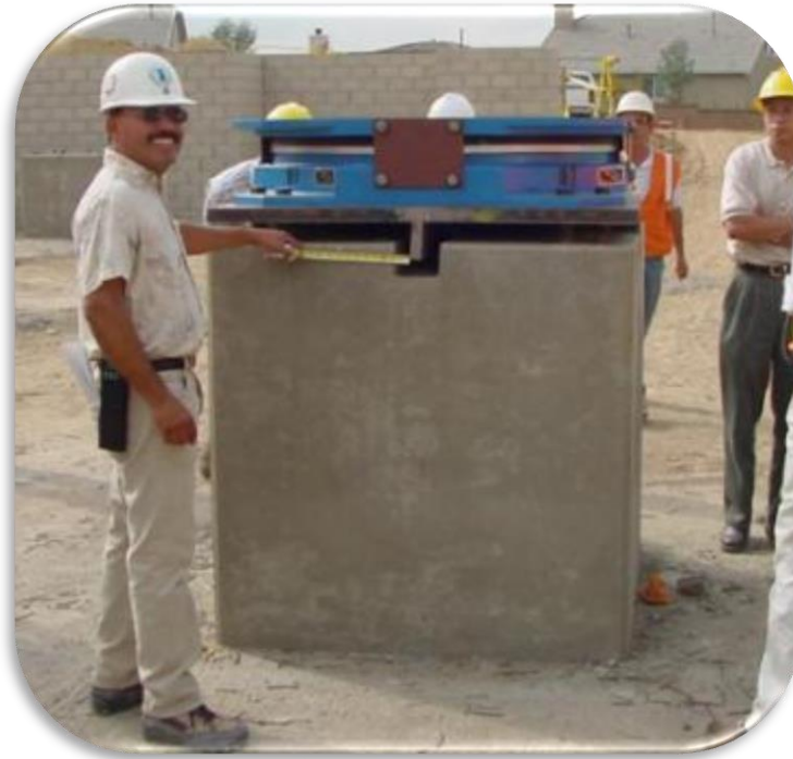
شکل ۶ سیستم جداساز لرزه‌ای پاندول اصطکاکی (FPS)
